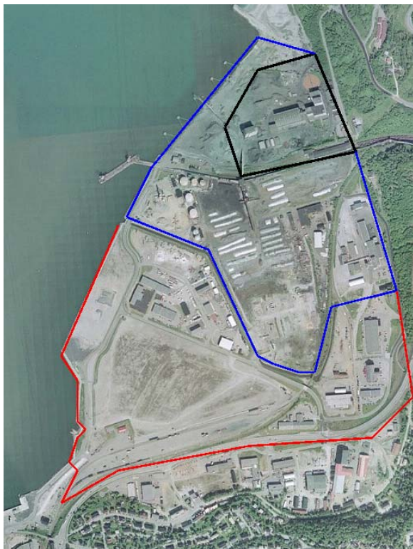
Figur 3 Utbyggingstrinn for Vikaområdet: Koksverkstomten gjennom årene fra Dunderland Iron Ore (DIOC) sitt oppredningsanlegg og utskipningskai ved Gullsmedvika rundt 1900 (svart linje) til utbygging for Norsk Koksverk AS på midten av 1960-tallet (blå linje) og utfylling for havne- og næringsformål (rød linje) på midten av 1990-tallet. DIOCs oppredningsverk ligger dels på naturlig grunn.
