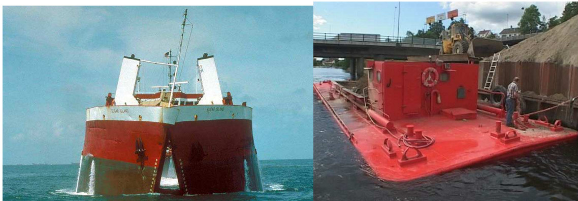
Figur 3-1. Splittlekter (til venstre) og fallbunnslekter (til høyre). Fallbunnslekteren er den som ble brukt ved tildekkingen i Kristiansand havn.
