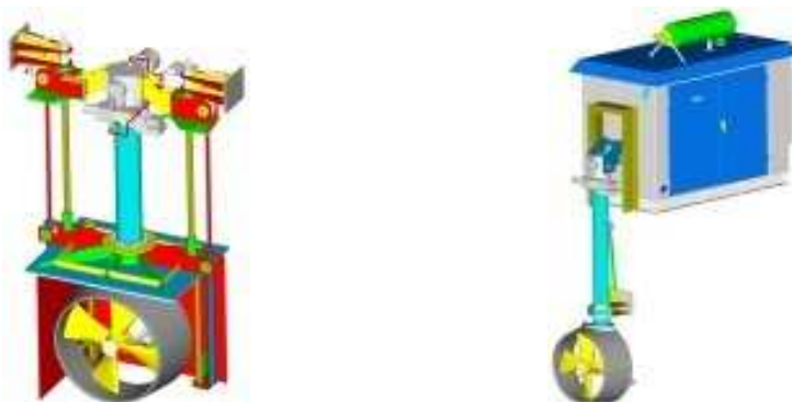
Figur 5-1. Venstre: Fremre propeller av den typen som som brukes ved Malmøykalven. Den er nedsenkbar slik at den stikker under skrogbunnen og den har full effekt 360 grader. Høyre: Bakre (aktre) propeller (to stk.) av den typen som som brukes ved Malmøykalven. Kan rotere 360 grader men kan ha noe begrenset effekt i visse posisjoner.
