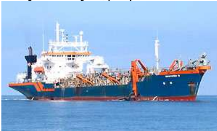
Figur 3-3. Selvgående skip med sugeenhet og mudringsarmer (dragarms)
