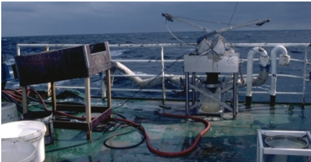
Figur 3.4. Grabb, mottaksbord, målesylinder og vaskebord benyttet på Mikkel A og B (bildet er fra tilsvarende feltarbeid gjennomført på Haltenbanken i 2000).
