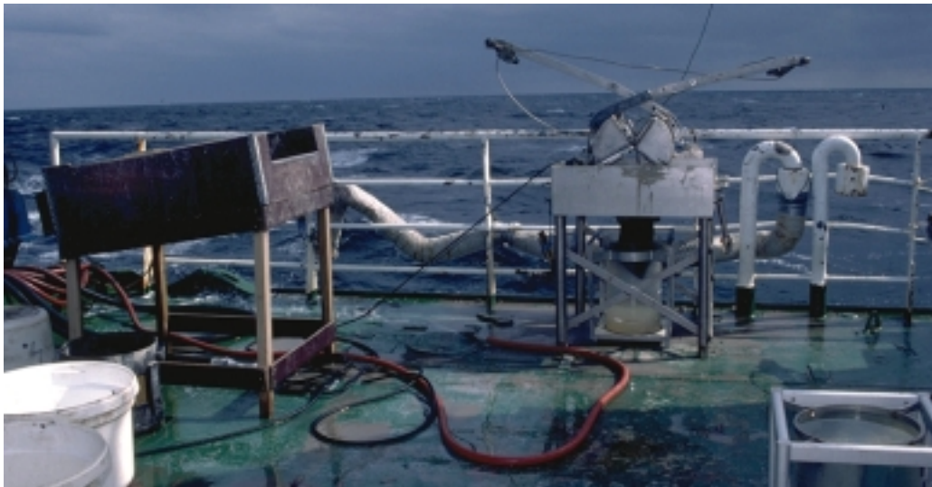
Figur 3.2. Grabb, mottaksbord, målesylindere og vaskebord benyttet på Rogn Sør (bildet er fra feltarbeid gjennomført på Haltenbanken i 2000).
